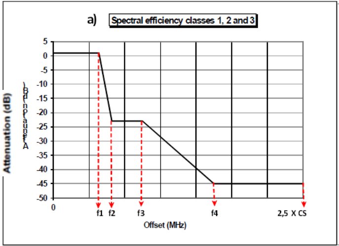
Gambar 2. Referensi Bentuk Spectrum Mask untuk Spectral Efficiency Class 1, 2, dan 3
