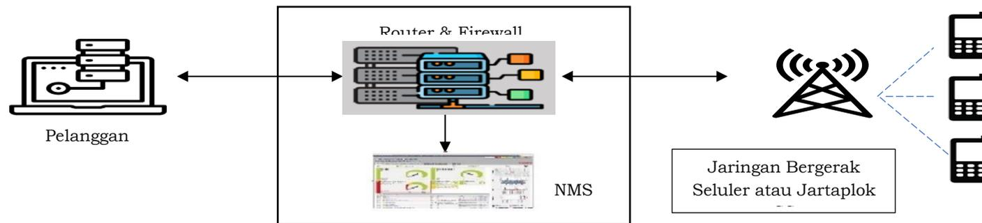
Keterangan untuk keseluruhan konfigurasi: Sistem *back end* (LAN, *Agent*, NMS) tidak dapat digunakan untuk trafik lain.
